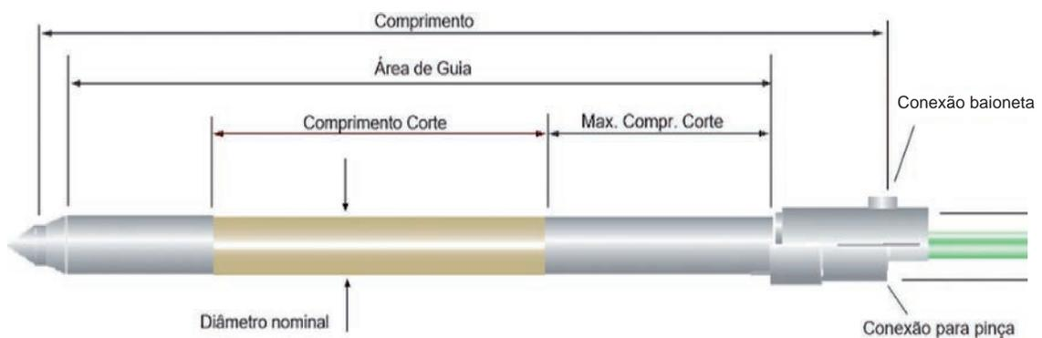
O brunimento ocorre normalmente em um passo (ou mais em casos especiais). A ferramenta é ajustada permanentemente para o diâmetro de usinagem, tornando o processo particularmente estável. A compensação de desgaste pode ocorrer automaticamente, se necessário.
